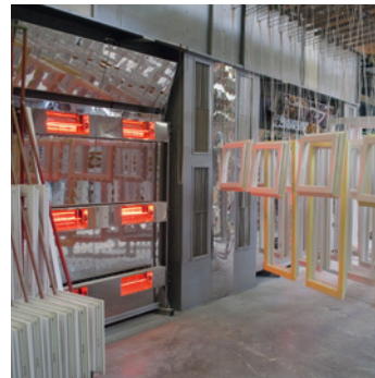
Oberflächen für höchste Ansprüche: Halogen-Trocknungsanlage
