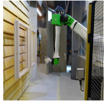
Lackauftrag durch moderne Spritzroboter, für optimale Lackmaterialstärke
